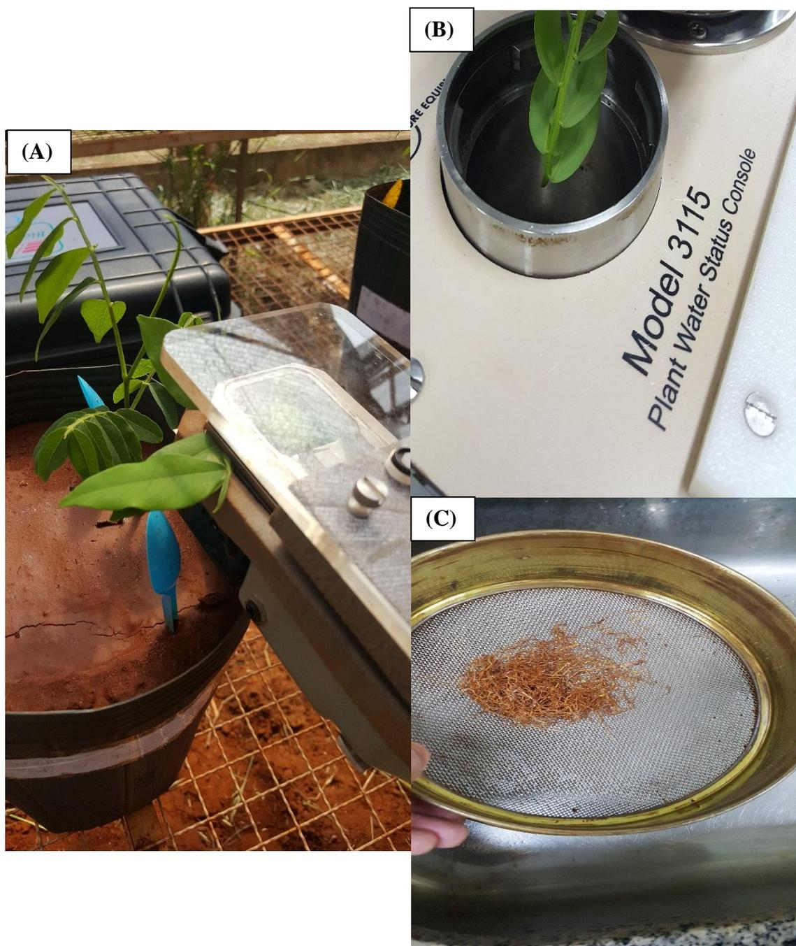
FIGURA 3. Avaliação de trocas gasosas em mudas de *D. alata* utilizando o equipamento IRGA (A); avaliação do potencial hídrico em folhas de *D. alata* utilizando câmara de pressão (B); lavagem de raízes das mudas de *D. alata* em peneira para avaliação de parâmetros micorrízicos (C).
